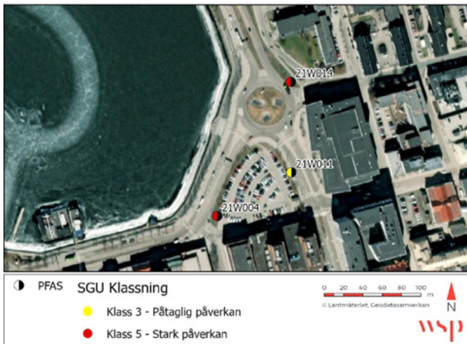
Figur 35 Översiktlig föroreningsituation för grundvatten (Översiktligt geotekniskt och markmiljötekniskt utlåtande Trekanten, WSP, 2)
