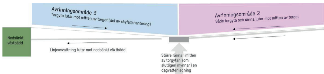
Figur 34 Schematisk bild som visar en genomskärning av torget och principen för linjeavvattningen (Sweco, 2022).
