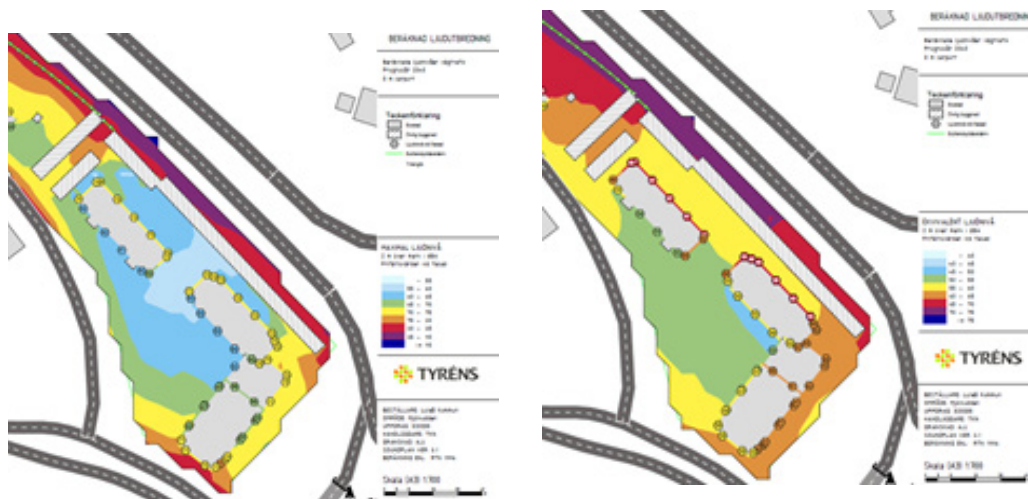
Figur 20 Resultat från beräkning av ekvivalent bullernivå till vänster och maximal bullernivå till höger (Tyrens, 2022)
