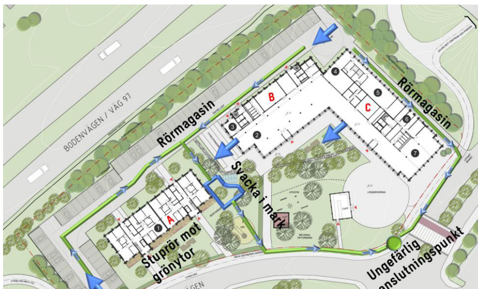
Figur 18 Förslag på systemlösning för dagvattenhantering inom planområdet (Sweco, 2022)
