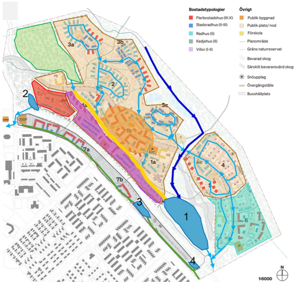
Figur 11. Föreslagen dagvattenhantering för aktuellt programområde. Ljusblå pilar visar sträckor där svackdiken föreslås anläggas för ytlig avledning av dagvatten, föreslaget tvåstegsdike visas i gult och föreslagna dagvattendamm (numrerade 1-4) visas i blått. Sankt område i nordväst visas i grönt. Område 7a, 7b och 8 föreslås anslutas till dagvattenledning (visas i grönt och inom området inringat i rött behöver en mindre dagvattendamm (dagvattendamm nr 2) anläggas vilken avleds via dike. Lila område föreslås avvattnas ytligt, norrut mot föreslaget tvåstegsdike. Orange område avleds ytligt söderut till tvåstegsdiket.
