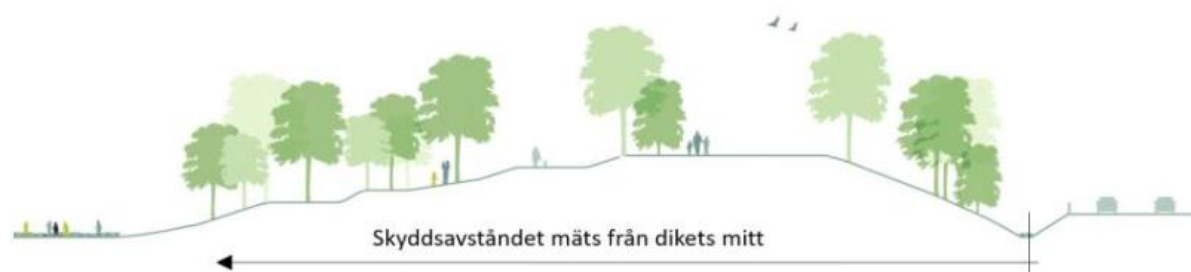
Figur 6 Illustration hur angivet skyddsavstånd ska mätas då det finns ett dike. [1]
