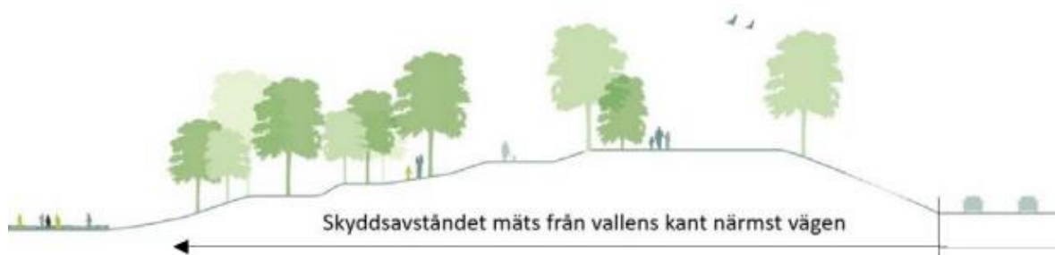
Figur 5 Illustration hur angivet skyddsavstånd ska mätas då det finns en vall eller dylikt mot transportleden. [1]
